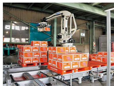
◀ミカン箱を規格ごとに自動で仕分け、パレットに積み上げるロボットパレタイザー
