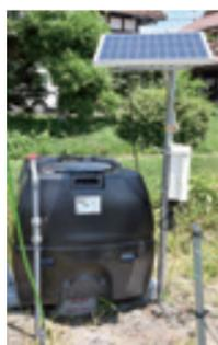
▶日射比例型拍動式かん水装置「ソーラーパルサーE」
